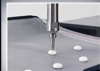
ドアパネルにマスチックシーラーを塗布
