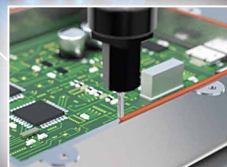
BMSに液状ガスケットを線塗布
